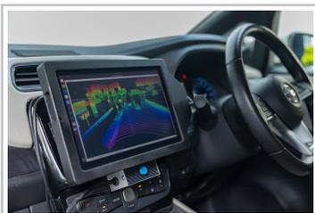
Ein mit 14 Kameras, zehn Radar- und sechs Lidarsensoren bestückter Leaf dient Nissan als Prototyp für autonomes Fahren.
