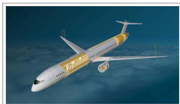
Flugzeugkonfiguration Wasserstoff-Mild-Hybrid mit Wasserstoff-Direktverbrennung und Brennstoffzellen zur Unterstützung. Wasserstoff-betriebene Flugzeuge können die Klimaauswirkungen um mindestens 80 Prozent reduzieren.
