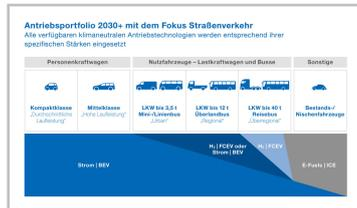
Das Antriebsportfolio 2030+: Nur mit einem intelligenten, technologieoffenen Mix aus allen verfügbaren klimaneutralen Antriebstechnologien - Batterie, Brennstoffzelle und E-Fuels - kann das ambitionierte Klimaziel der EU "Zero Emission" erfüllt werden.
