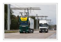
Siemens baut auf einem Testfeld auf der A 5 bei Frankfurt eine Oberleitung für Hybrid-Lkw.
