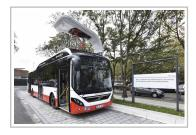
Die Hamburger Hochbahn setzt ab Dezember 2014 drei Volvo 7900 Electric Hybrid auf der Innovationslinie 109 ein. Die Fahrzeuge beziehen ihren Strom jedoch nicht aus der Oberleitung, sondern werden an speziellen Schnell-Lade-Terminals wieder aufgeladen.
