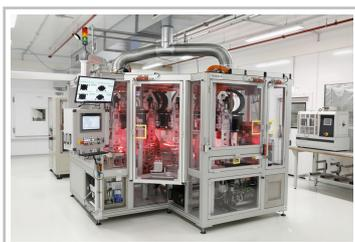
VW Center of Excellence „Batteriezelle“: Stacker.
