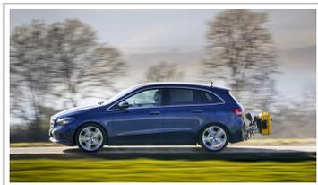
Als Teil der WLTP-Zertifizierung muss die Einhaltung der Grenzwerte in einem so genannten RDE-Straßentest (Real Driving Emissions) nachgewiesen werden. Hierfür werden die Entwicklungsfahrzeuge mit portabler Emissionsmesstechnik (PEMS = Portable Emission Measurement System) ausgestattet. Die Messkoffer sitzen auf der Anhängerkupplung oder finden im Kofferraum Platz.
