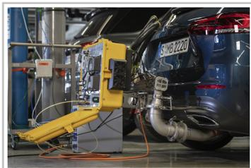
Abgasmessung bei Daimler.
