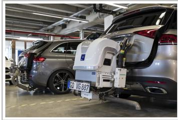
Als Teil der WLTP-Zertifizierung muss die Einhaltung der Grenzwerte in einem so genannten RDE-Straßentest (Real Driving Emissions) nachgewiesen werden. Hierfür werden die Entwicklungsfahrzeuge mit portabler Emissionsmesstechnik (PEMS = Portable Emission Measurement System) ausgestattet. Die Messkoffer sitzen auf der Anhängerkupplung oder finden im Kofferraum Platz.
