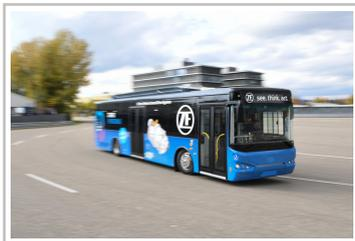
ZF-Versuchsträger mit dem elektrischen Zentralantrieb Cetrax.
