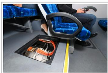
ZF-Versuchsträger mit dem elektrischen Zentralantrieb Cetrax.
