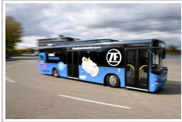
ZF-Versuchsträger mit dem elektrischen Zentralantrieb Cetrax.
