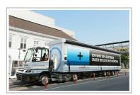
BMW setzt für den Teiletransport zum Werk München einen rein elektrisch betriebenen 40-Tonner des niederländischen Herstellers Terberg ein.
