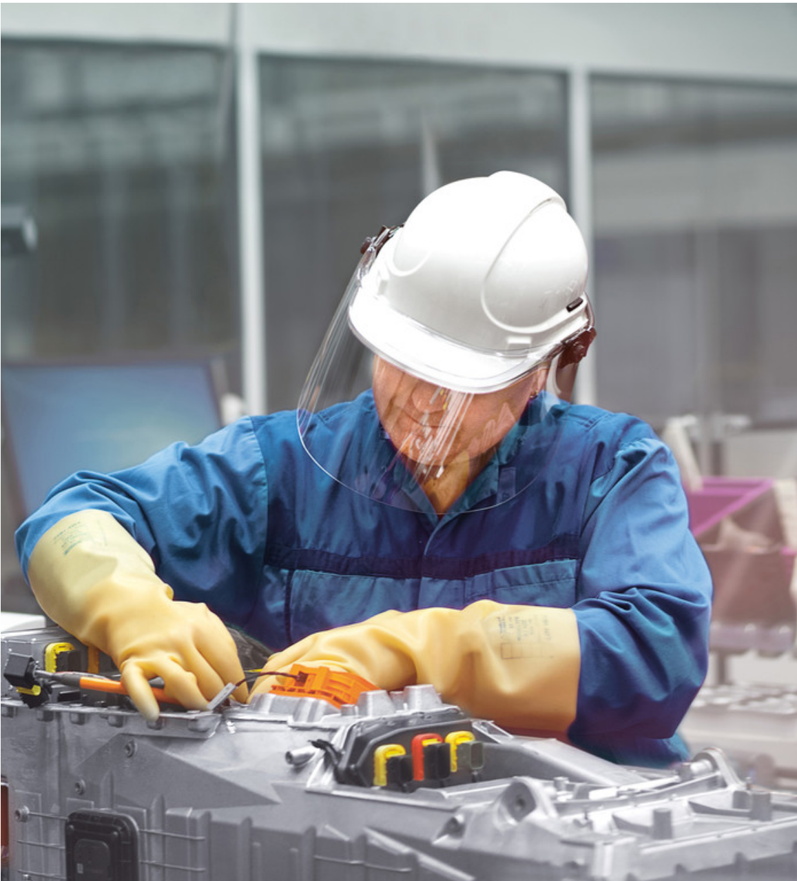
Produktion des BMW C Evolution: Montage der Batterie.
