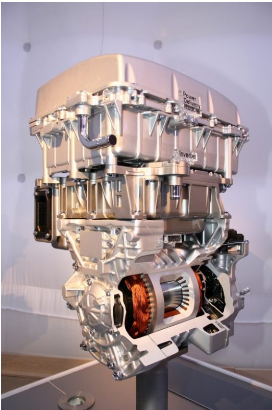
Motor des Nissan Leaf. Schnittmodell des Nissan Leaf.
