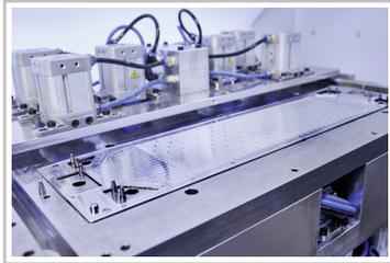
Metallische Bipolarplatten sind ein Schlüsselement der Brennstoffzellen-Stacks.
