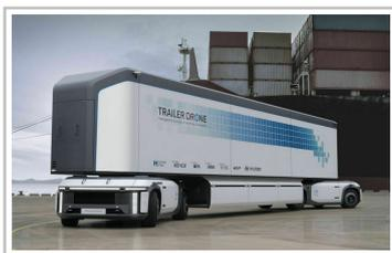
Die Brennstoffzelle bei Hyundai: Die Trailer Drone mit jeweils einem motorisierten Drehgestell vorn und hinten.
