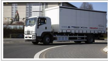
Prototyp eines elektrischen 18-Tonnens der RWTH Aachen und von Isuzu.
